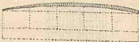
Fig. 14. Corte do modelo reduzido d'aza Wright, experimentada por Eiffel. Este modelo tinha 900 m de envergadura.
