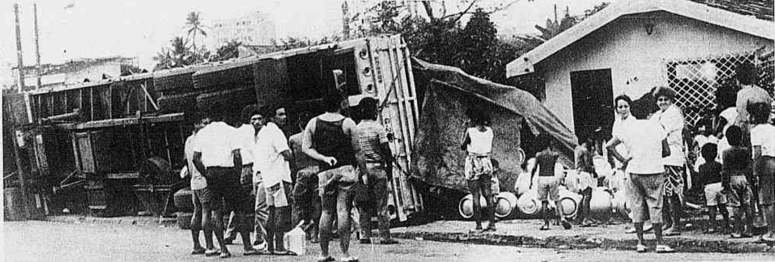
A má distribuição da carga fez com que a carreta virasse no meio da rua. Os botijões de gás acabaram espalhados no chão.
